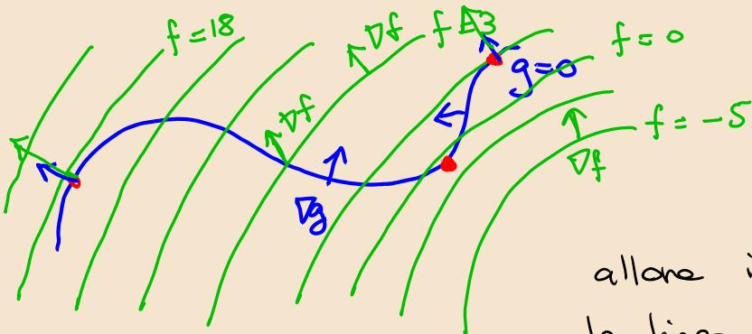
Poiché  $\nabla f$  è  $\perp$  alle linee di livello di  $f$  e  $\nabla g$  è perpendicolare a  $g=0$  (linea di livello 0 per  $g$ )
